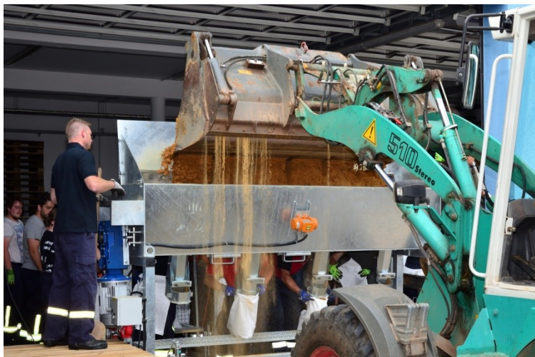
Ein Lader befüllt die Anlage mit Sand.
