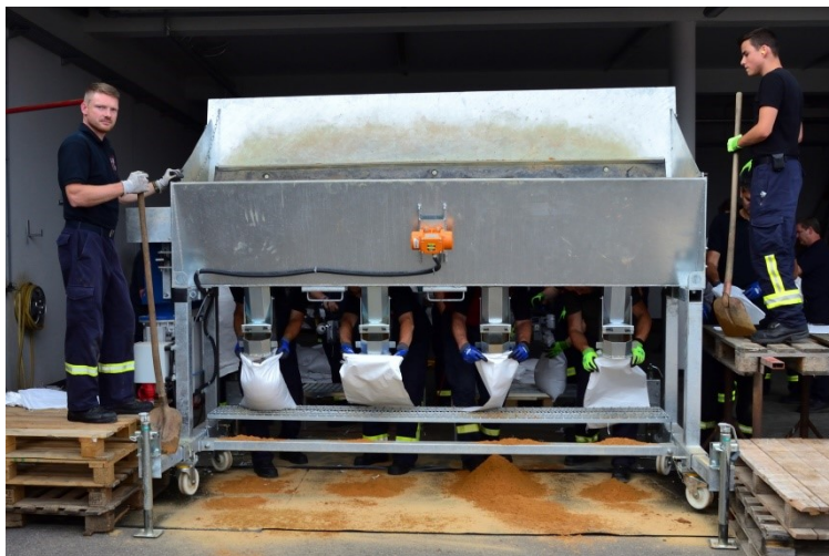
Vier Säcke können gleichzeitig mit Sand gefüllt werden.
