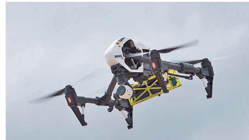
Dieser „Rettungsscopter“ kann mit 65 Kilometern pro Stunde übers Wasser fliegen und eine Schwimmhilfe neben Verunglückte fallen lassen. FOTO: SAUER/DPA
