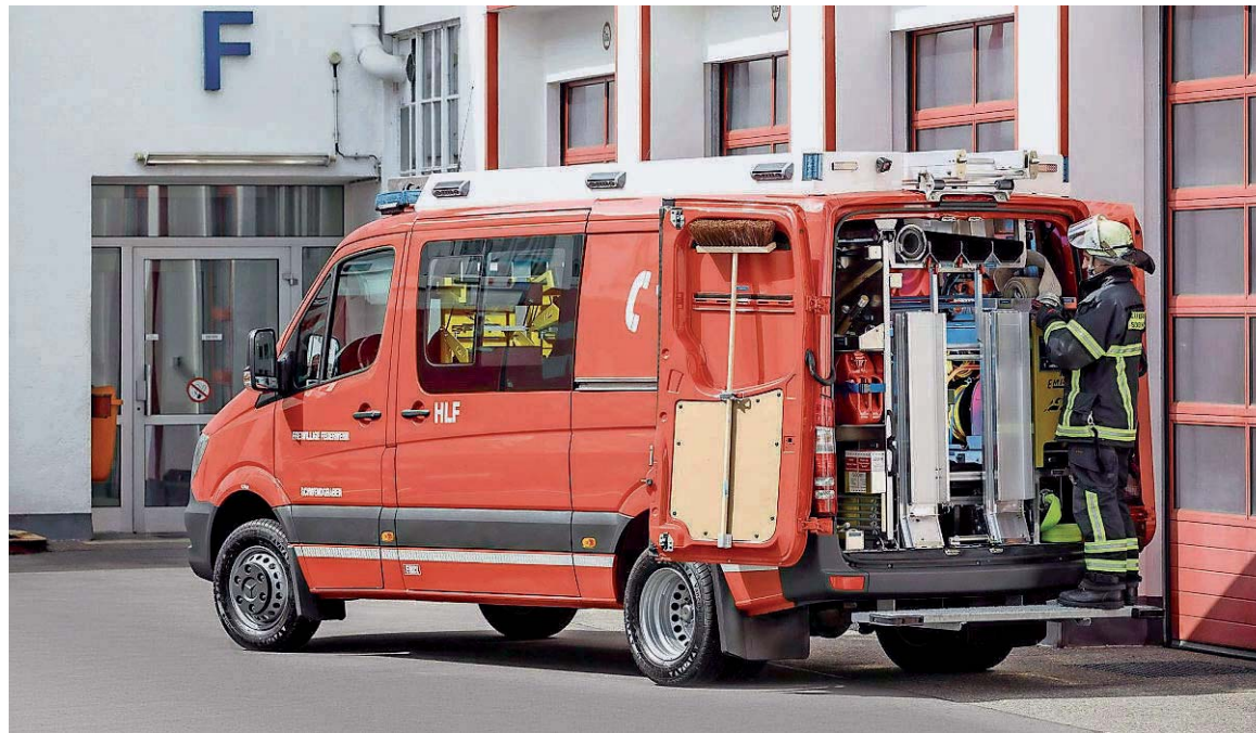
Da in Feuerwehrautos und Krankenwagen viel Material transportiert werden muss, hat Mercedes-Benz das zulässige Gesamtgewicht des Sprinter, der oft als Basisfahrzeug dient, erhöht. FOTOS: DAIMLER
